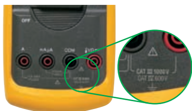
Käytä näillä merkinnöillä varustettuja mittareita: 1000 V CAT III tai 600 V CAT IV
